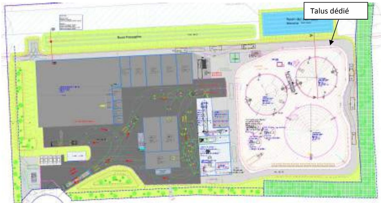
Figure 27 Localisation des moyens mis en place pour retenir la matière en cas de débordement des cuves
